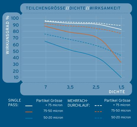
Die angegebenen Wirkungsgrade basieren sowohl auf theoretischen Berechnungen als auch auf Betriebsversuchen. Die zu erwartende Leistung variiert aufgrund von Abweichungen der Teilchenform, der Differenzdrücke, der Menge an anhaftendem Öl und Gasen, etc. Diese Daten dienen nur zur unverbindlichen Information.
