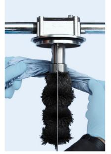
Der angesammelte Metallanteil wird nun mit einem festen Lappen vom Magnetstab abgereinigt. Eine vollständige Abreinigung ist dabei nicht erforderlich da es sich um die Schmutzseite des Magnetabscheiders handelt.
