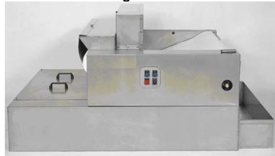
Abbildung: Bandfilter, Tank und Sammelbehälter.
