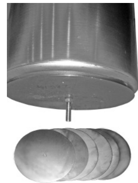
Skimmerboden mit aufgesetzten Ausgleichscheiben (-gewichten)
